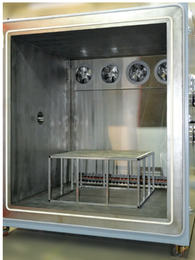
Рабочий объем испытательной термобарокамеры большого объема со столом для размещения испытываемых образцов
