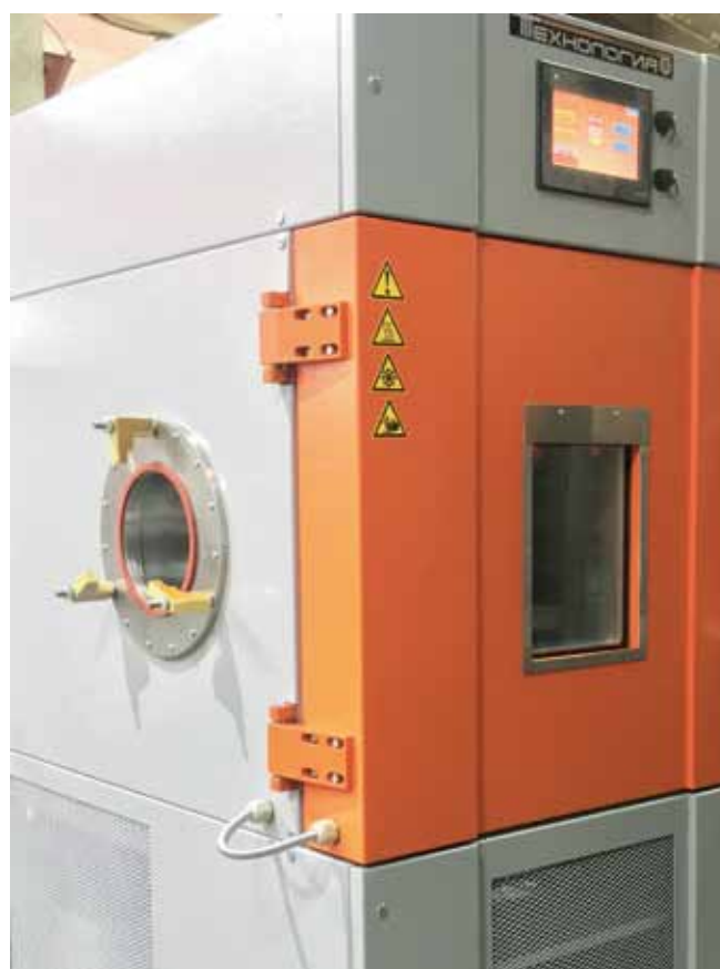
Рис. 3. Камера КТХВ-150 с нестандартным технологическим отверстием
