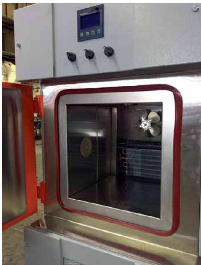
Рис. 2. Рабочий объем климатической камеры тепла-холода (КТХ)
