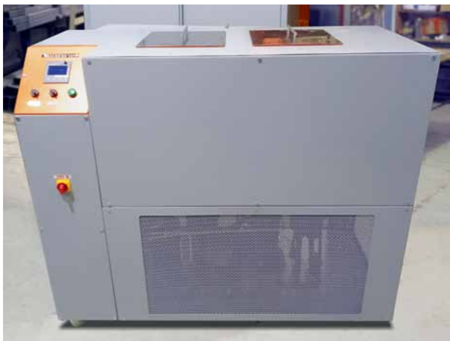
Рис. 4. Нестандартная камера тепла-холода (вертикальная загрузка)
