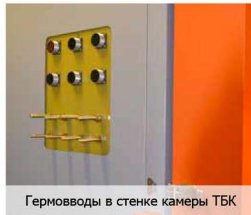
Гермоводы в стенке камеры ТБК
